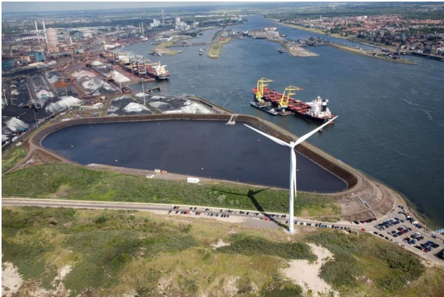
Figuur 2.1 Huidige situatie depot met ringdijk (+15M NAP) van staalslakken en lichterlocatie
